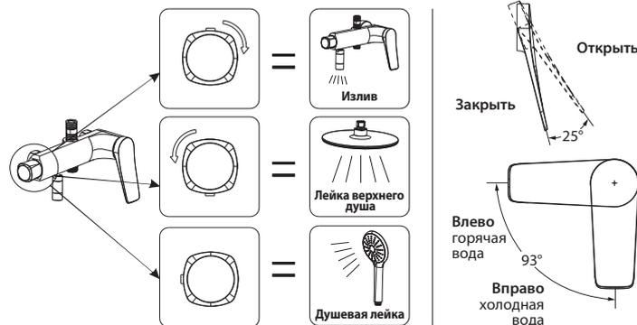
Смеситель оснащён картриджным переключателем, конструкция которого устойчива к гидроударам в момент переключения потоков воды с излива на душевые лейки и обратно.
