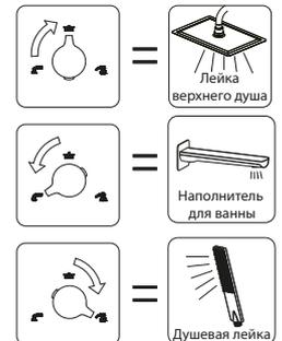
**Смеситель оснащён картриджным переключателем, конструкция которого устойчива к гидроударам в момент переключения потоков воды с наполнителя на душевые лейки и обратно.**
