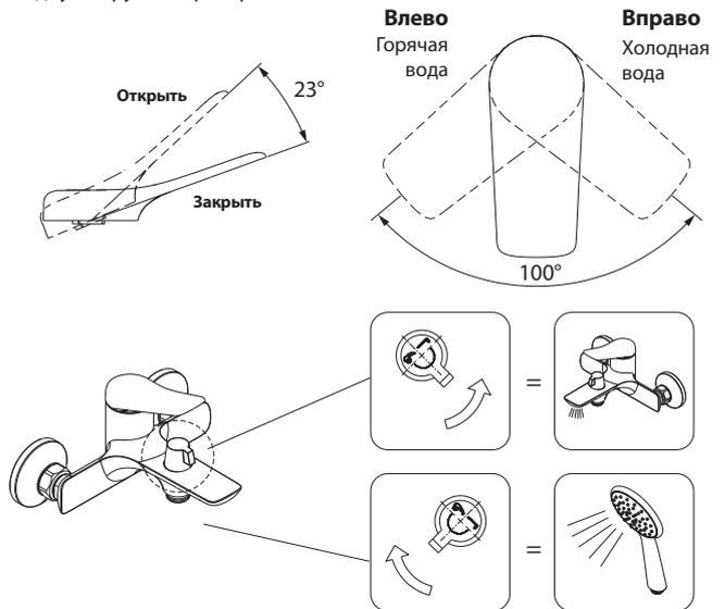
Смеситель оснащён переключателем-дивертором с керамическими пластинами, конструкция которого устойчива к гидроударам в момент переключения потоков воды с излива на душ и обратно.
