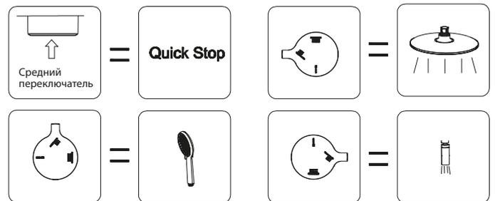
Смеситель оснащён картриджным переключателем, конструкция которого устойчива к гидроударам в момент переключения потоков воды с излива на душевые лейки и обратно.
