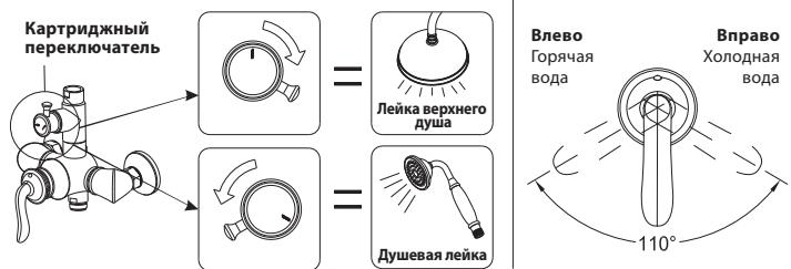
Смеситель оснащён картриджным переключателем, конструкция которого устойчива к гидроударам в момент переключения потока воды с лейки верхнего душа на душевую лейку и обратно.
