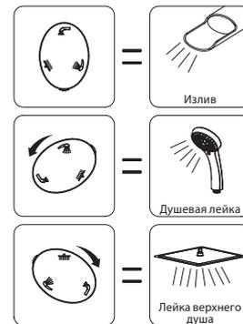
Смеситель оснащён картриджным переключателем, конструкция которого устойчива к гидроударам в момент переключения потоков воды с излива на душевые лейки и обратно.
