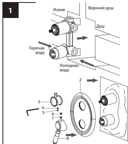
1. Подготовьте в стене каналы для размещения в них узлов встраиваемого смесителя и соединительной арматуры (в комплект не входит). Габариты посадочного места в стене для установки корпуса смесителя должны быть 80 мм в длину и 160 мм в высоту. Для удобства установки глубина посадочного места для размещения корпуса смесителя должна быть не менее 50 мм и не более 75 мм от внешней облицовки;
